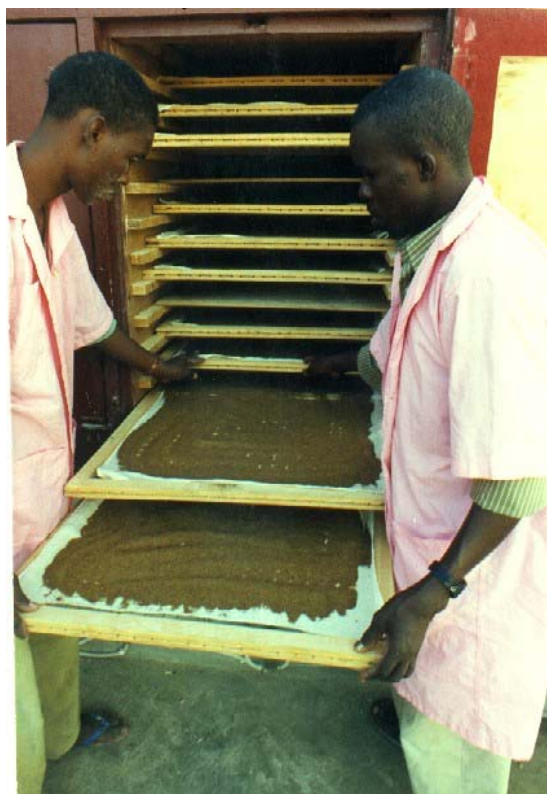
Séchoir à gaz ITA/Sénégal Photo ; source : Infoconseil
